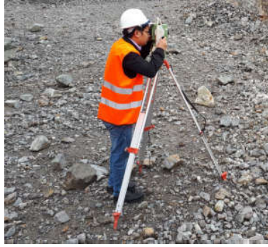
H.4. Đo đạc chi tiết trên thực địa bằng máy toàn đạc điện tử
