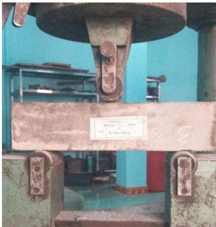
Рисунок 2 - Испытание прочности на изгиб
