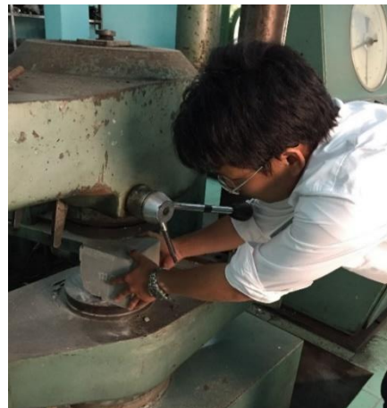
Рисунок 3 - Испытание прочности на сжатие
