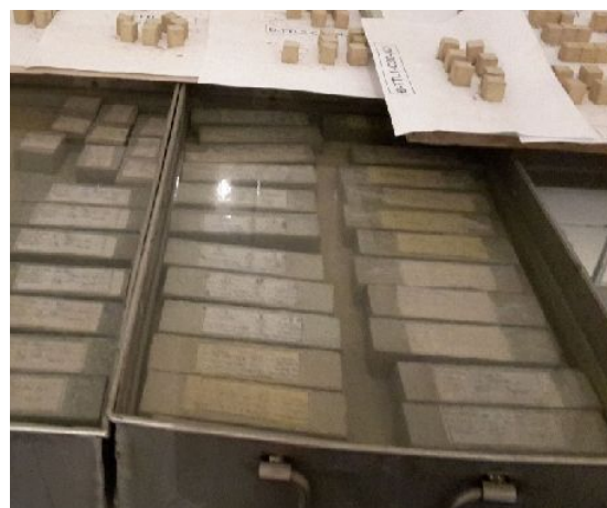
Рис. 3. Экспериментальные образцы из цементно-шлаково-песчаных растворов
