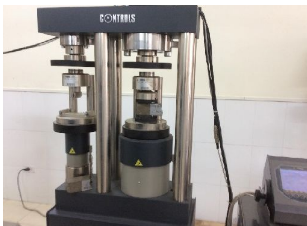
Рис. 2. Определение прочности образцов на сжатие
